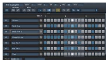
画面3 ビンテージ・リズムマシンのように、各ステップのボタンをON/OFFして発音タイミングを指定しながら打ち込む「ステップシーケンサー」が内蔵された
