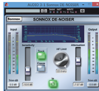
画面3 「サー」というヒスノイズの除去に特化しているのが「De-Noise」だ。ノイズ成分を認識して、トラック中からそのノイズ成分だけを除去できる
