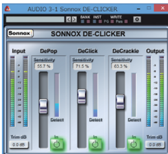
画面1 「ブチッ」といった瞬間的なノイズの除去に特化しているのが「De-Clicker」だ。操作は3種のノイズに対して除去の感度を設定するのみ、と簡単
