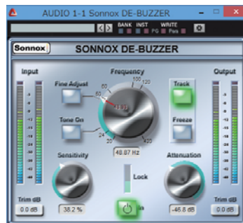
画面2 「ブーン」というハムノイズの除去に特化しているのが「De-Buzzer」だ。対象となるノイズの周波数を指定し、感度と除去のレベルを設定する
