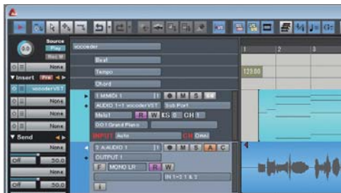
画面3 加工する歌声を録音したAudioトラックにVocoderVSTをインサートし、その内蔵シンセをMIDIトラックから演奏することで利用する
